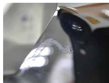
镀层的腐蚀点
